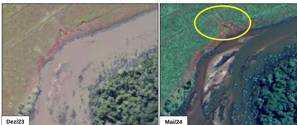
Figura 16: Áreas com pontos de assoreamento – aparentemente não alterado. O círculo amarelo apresenta um possível aumento no processo erosivo junto à margem.
