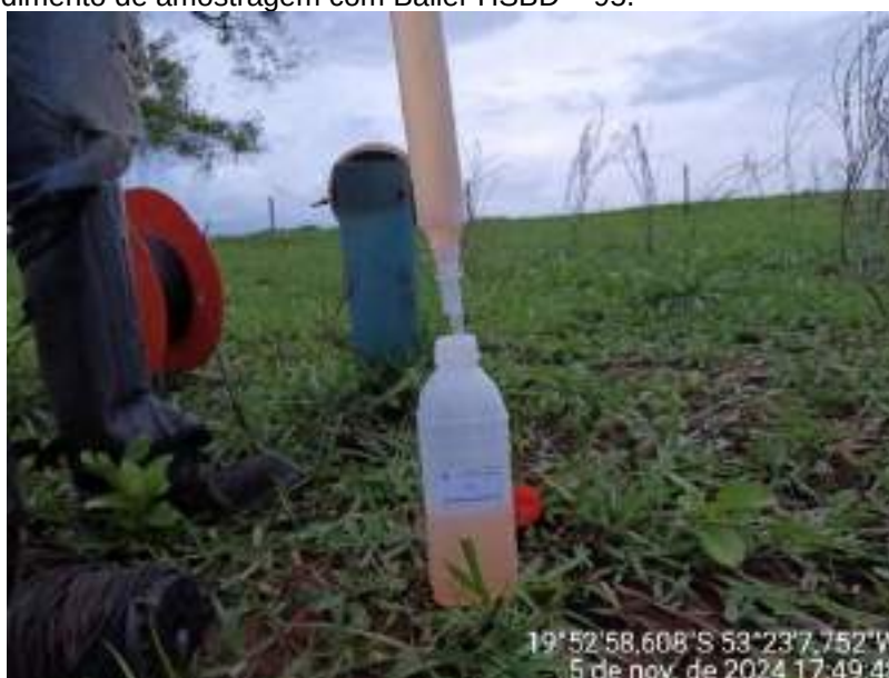
Figura 4 - Procedimento de amostragem com Bailer HSBD – 95.
