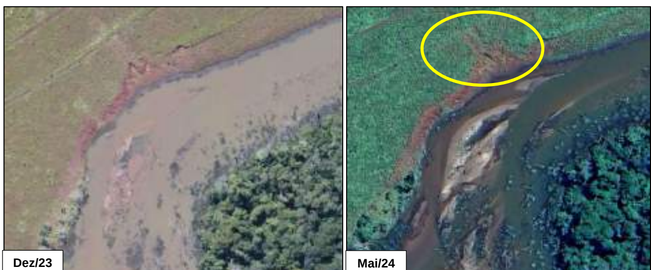
Figura 16: Áreas com pontos de assoreamento – aparentemente não alterado. O círculo amarelo apresenta um possível aumento no processo erosivo junto à margem.
