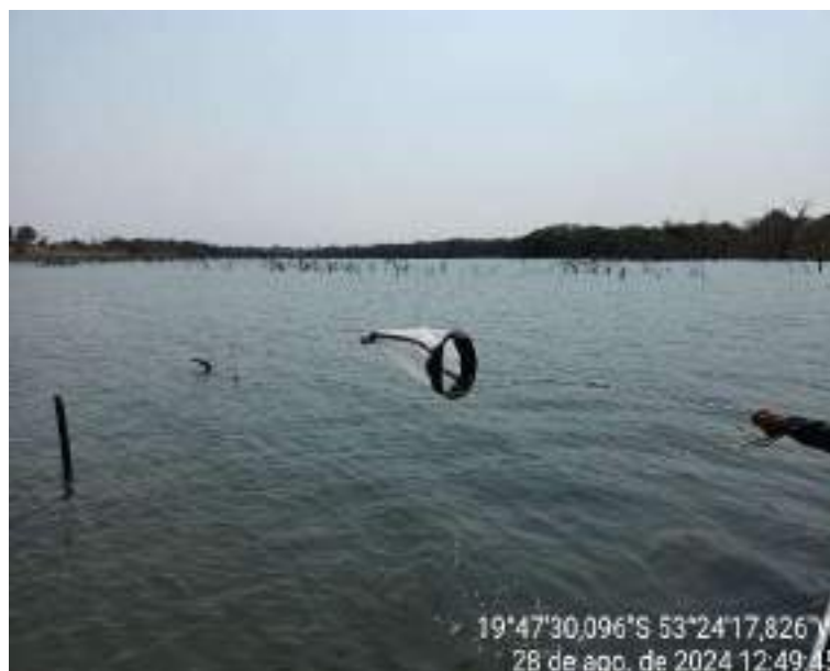
Figura 4. Coleta de amostras das comunidades fitoplanctônica e zooplancctônica por meio de redes de plâncton de 30 \mu e 60 \mu de porosidade, respectivamente. Fonte: ACARI, 2024.
