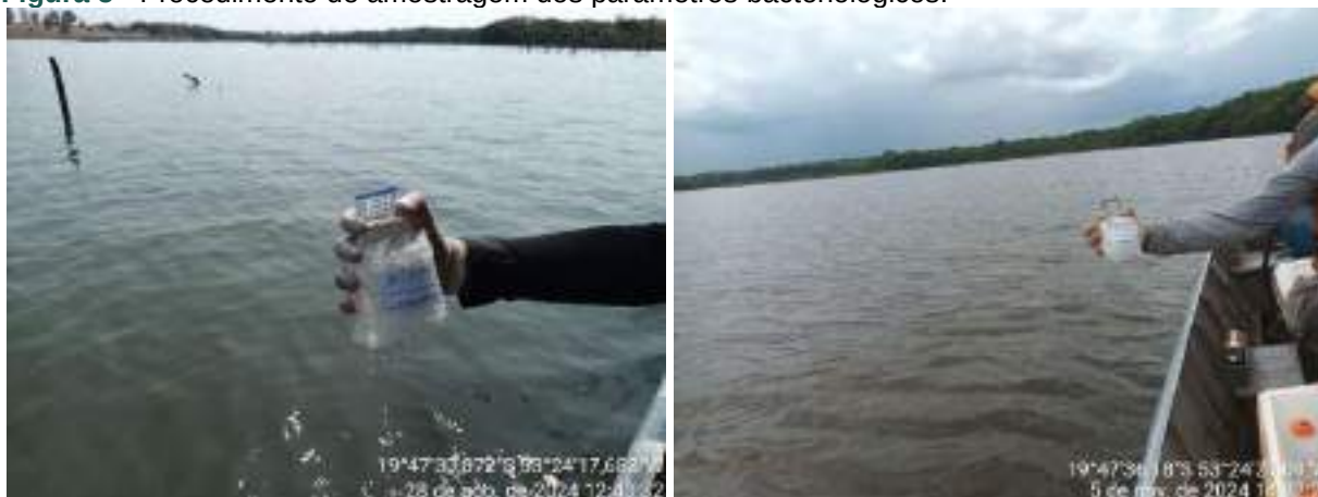
Figura 5 - Procedimento de amostragem dos parâmetros bacteriológicos.
