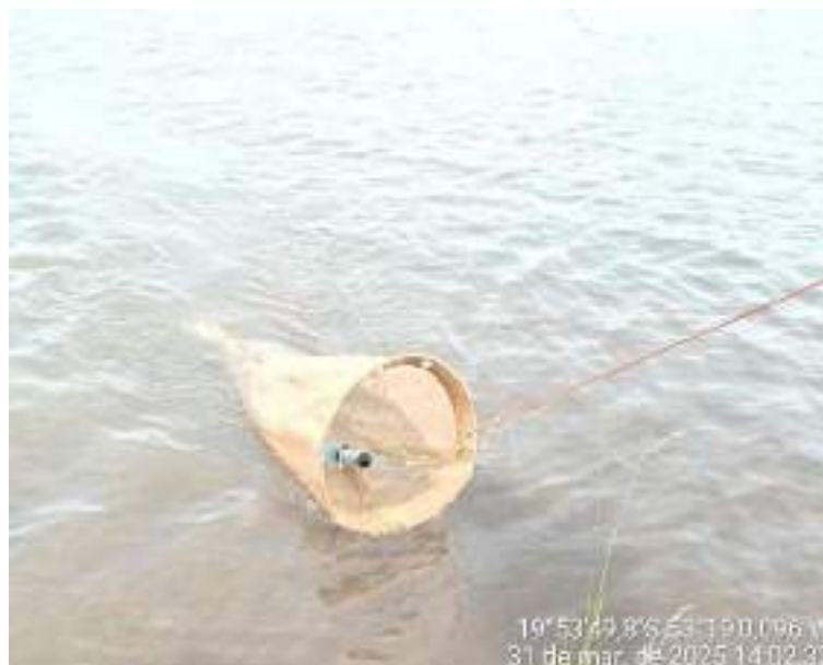
Figura 3. Rede cônica utilizada para coleta de ictioplâncton. Fonte: ACARI, 2025.
