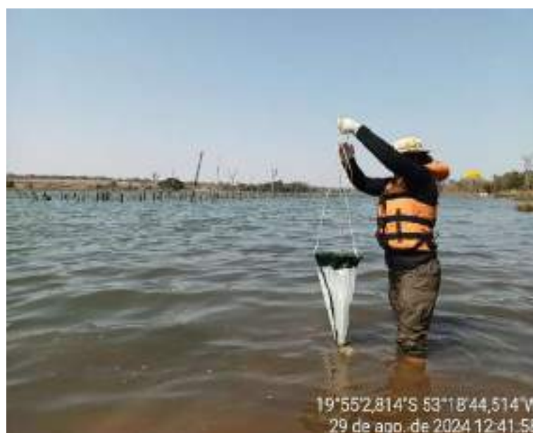
Figura 4. Coleta de amostras das comunidades fitoplancônica e zooplancônica por meio de redes de plâncton de 30 \mu e 60 \mu de porosidade, respectivamente. Fonte: ACARI, 2024.
