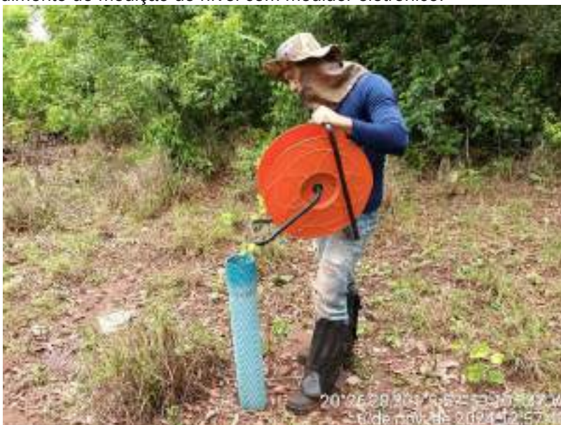
Figura 4 - Procedimento de medição de nível com medidor eletrônico.
