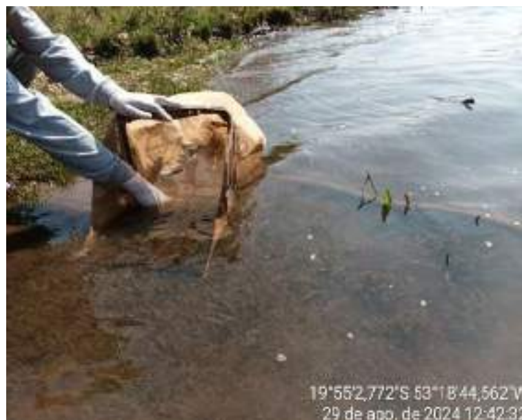
Figura 5. Procedimento de amostragem para análise da comunidade bentônica na área de monitoramento da PCH Verde 4. Fonte: ACARI, 2024.
