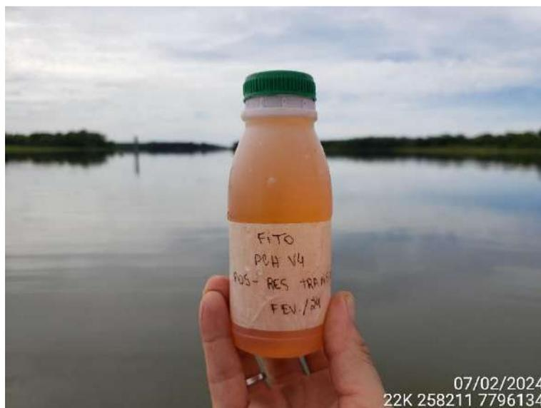
**Figura 3.** Frasco de polietileno utilizado durante as coletas de fitoplâncton na PCH Verde 4, Água Clara, MS. Fevereiro de 2024.
